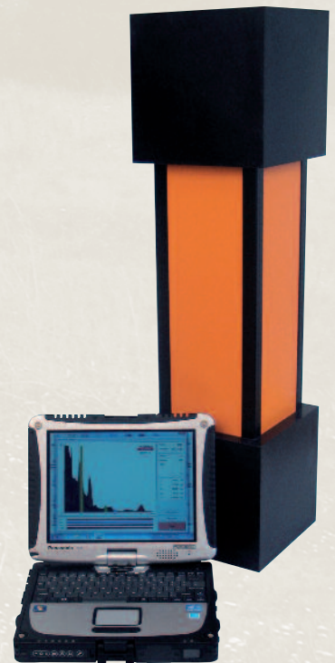
Sonda GS CAR NaI(Tl) 4''x 4''x 16'' (para vehículo)
